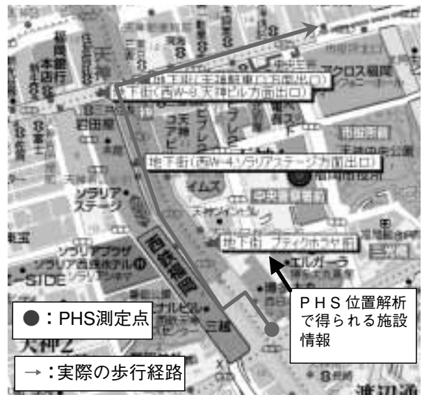
図-6 自営アンテナによる補正例（天神地下街回遊）
