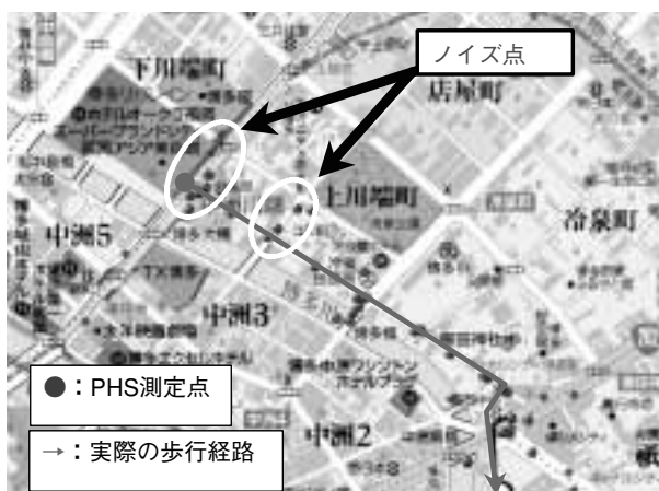
図-7 速度閾値による補正例 (中州川端地区アーケード街回遊)
