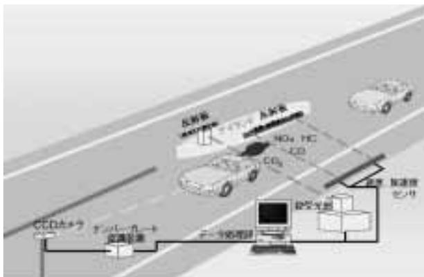
図-1 リモートセンシングによる計測の概念
