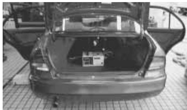
写真-1 車載型 NOx 計測器の設置例 (トランク)
