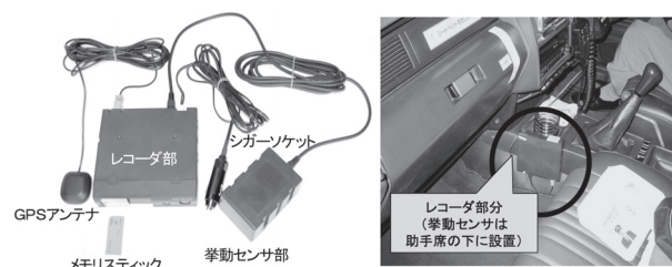
図-1 利用機器と設置の様子
