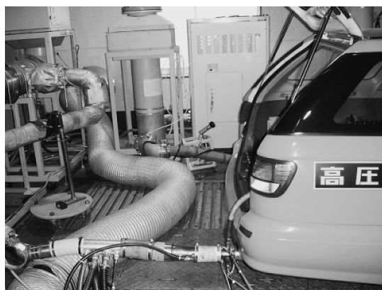
図-2 シャーシダイナモ装置と車載型計測器の計測風景
