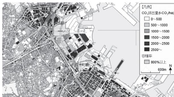
図-6 民生部門の CO<sub>2</sub> 排出量と容積率 (横浜市中心部)
