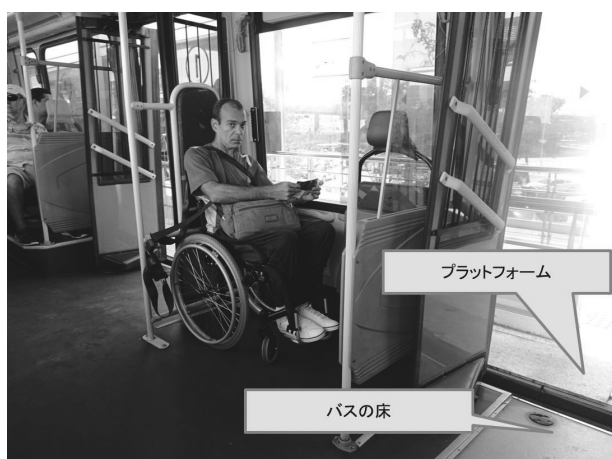
写真-6 水平に乗降できるよう工夫された停留所
