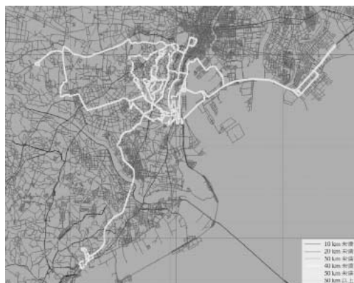
図13 プロブ・カーを用いた走行速度の計測例
