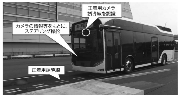
写真-1 正着制御システムの概略
