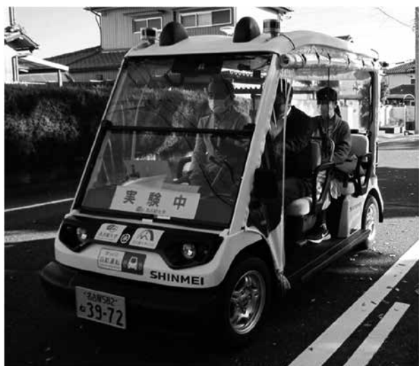
図-11 低速自動運転車両導入の社会実験の様子
