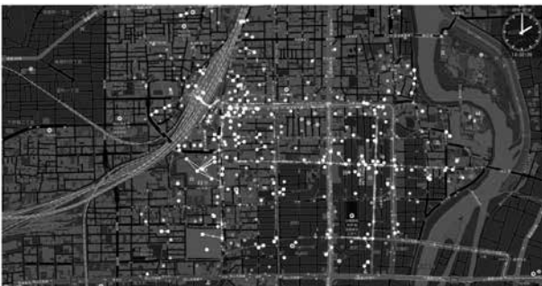
図-1 スマート・プランニングにおける 歩行者シミュレーションの可視化 (Mobmapを使用)
