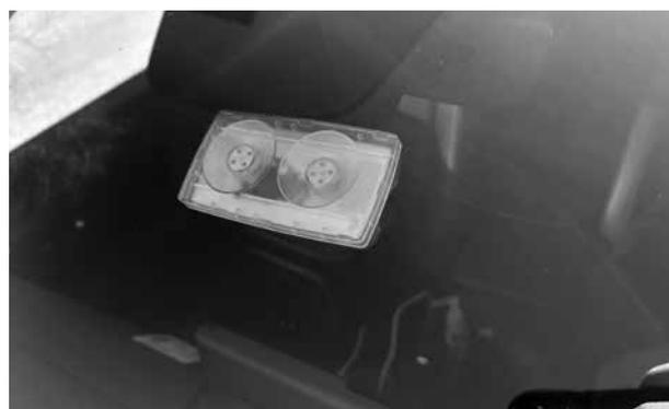
写真-2 フロントガラスに装着されたE-ZPass
