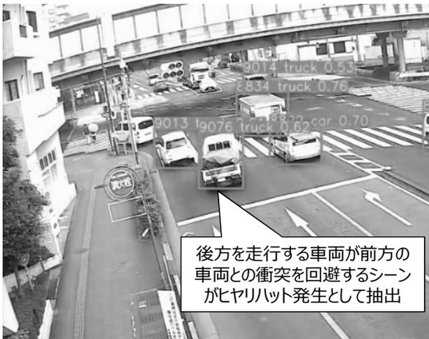
後方を走行する車両が前方の車両との衝突を回避するシーンがヒヤリハット発生として抽出
