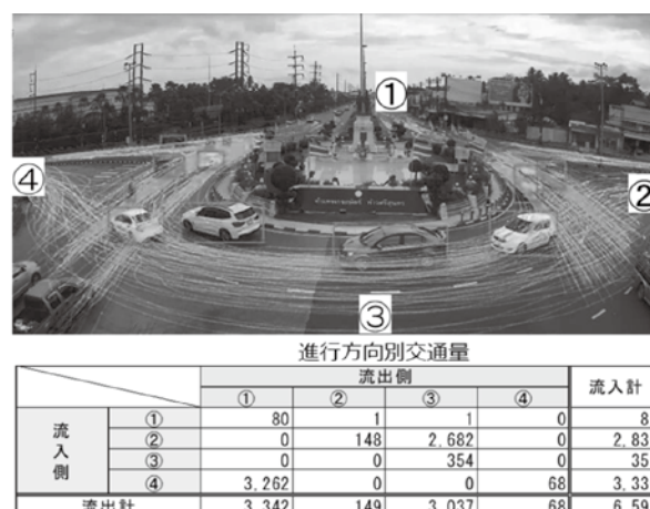
図-4 AI画像解析を用いた流動量推計例
