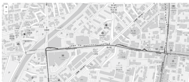
図ー 8 マップマッチングシステムによる経路推定の例
