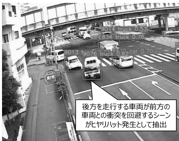
図-6 AI画像解析技術を用いた危険事象場面の検出
